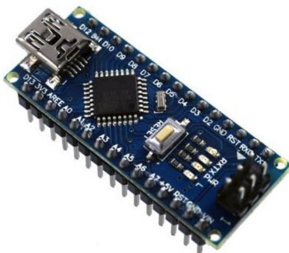
2.7 Сурет – Arduino Nano ATmega328P CH340G микроконтролері
